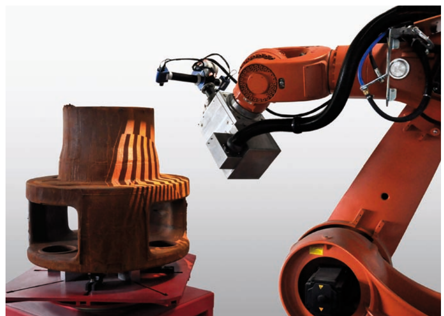
Bild 2: Dreidimensionales Scannen des Werkstückes.
